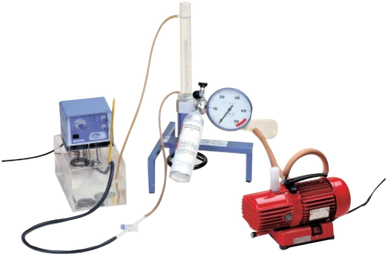
Les isothermes de compression d'un gaz dans un diagramme de Clapeyron  $P = f(V)$  montrent un comportement très différent selon la température.
